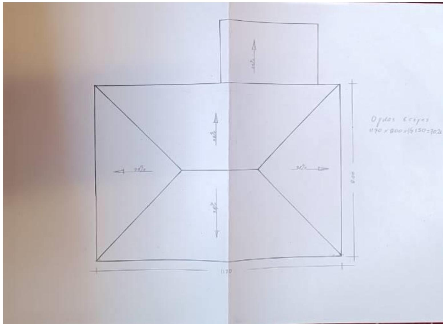
Κάτωση ξυλοτύπου οροφής ισογείου
